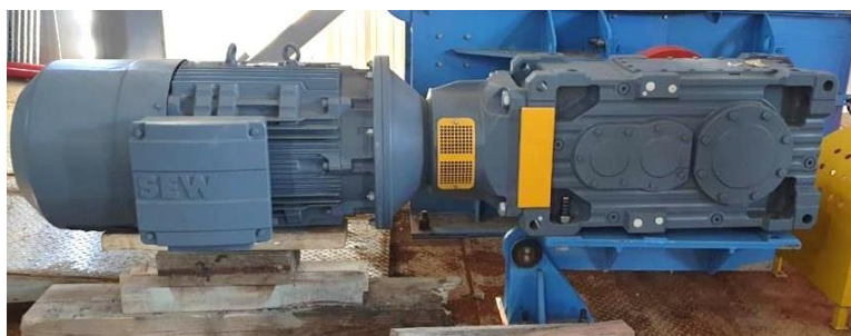
Коническо-цилиндрический редуктор со сплошным валом и фланцевой муфтой
