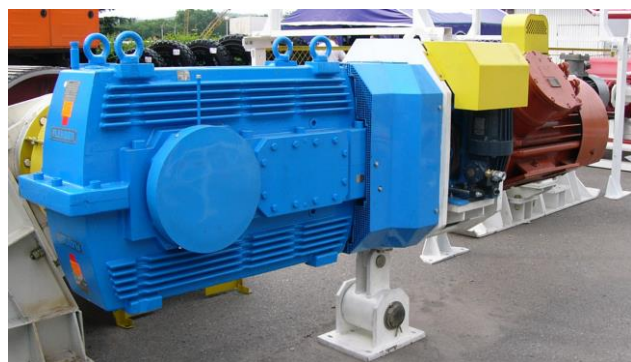
Навесная компоновка на приводном барабане (фланцевого типа с опорой момента)
