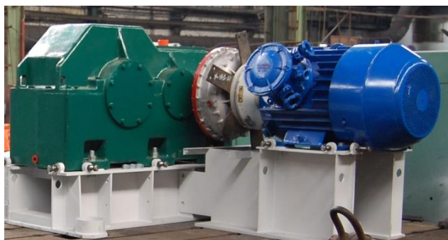
Навесная компоновка на приводном барабане (фланцевого типа с опорой момента)
