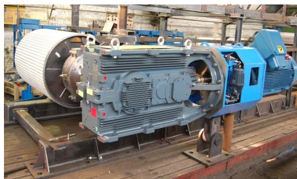
Навесная компоновка на приводном барабане (фланцевого типа с опорой момента)
